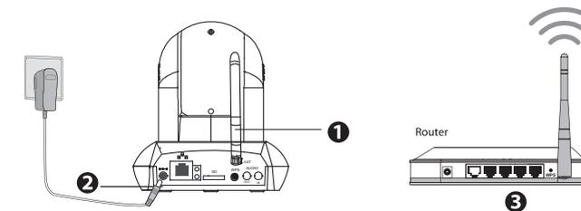
1. Instale la antena inalámbrica y colóquela de modo vertical.
